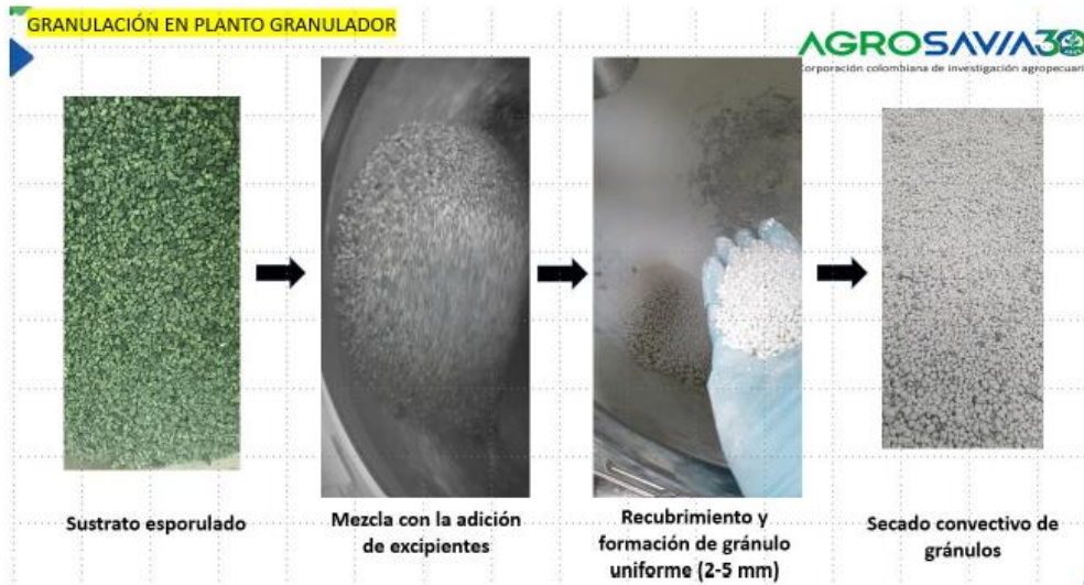
Figura 1. Representación esquemática del proceso de formulación de cepas de Trichoderma mediante la técnica de plato granulador
