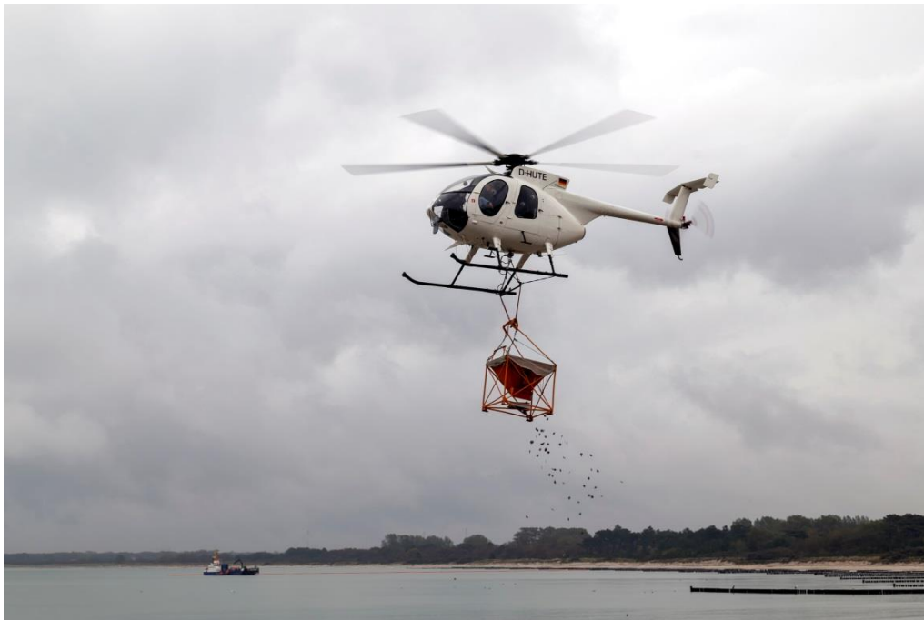
Abb. 1: Luftgestützte Binderausbringung mit Hubschrauber vom Typ „Hughes 500“ und Abwurfeinrichtung (im Hintergrund MS FLUNDER mit Ölsperre)
