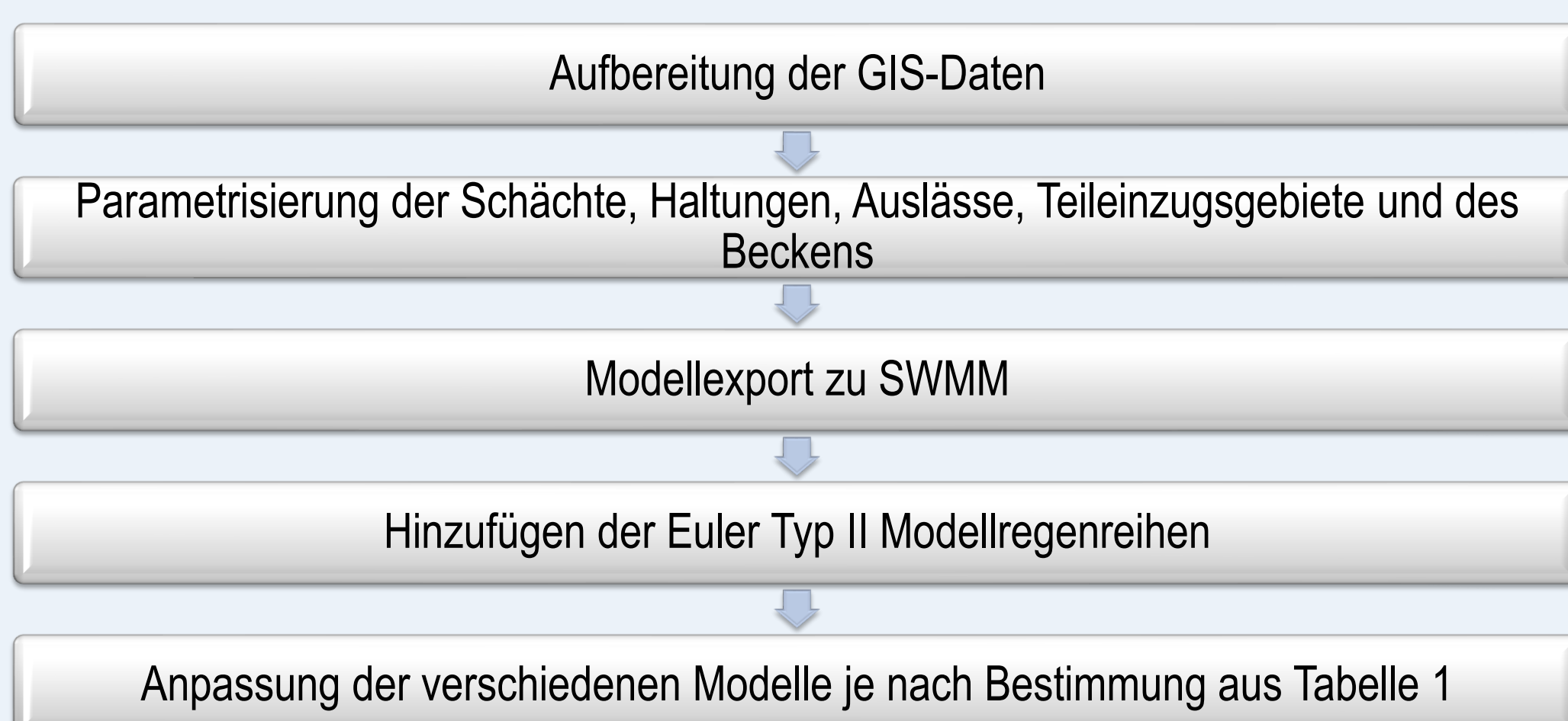
Abbildung 2 Vorgang des Modellaufbaus in QGIS und SWMM
