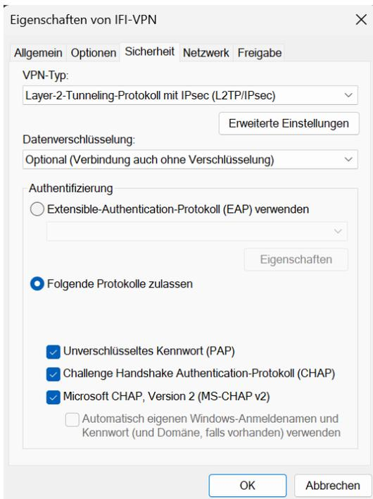
Abb. 2.3 Unter dem Tab Sicherheit → Folgende Protokolle zulassen: PAP und CHAP anwählen, speichern
