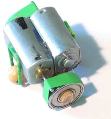
Abbildung 3: Luftballongummis als Antrieb und Stützräder aus Holzperlen
