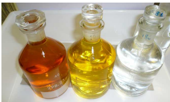
Abb. 3 Mit Schwefelsäure aufgelöster Niederschlag. Von links nach rechts: übersättigte Probe ist sehr dunkel, Niederschlag braucht 10-15 min zum Auflösen, leicht übersättigte Probe, sauerstofffreie Probe (muss nicht titriert werden).
