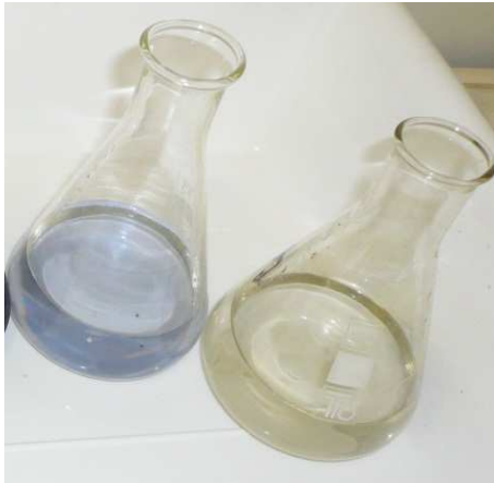
Abb. 4 Kurz vor dem Farbumschlag (links), nach einem (!) Tropfen Titrierlösung (rechts)
