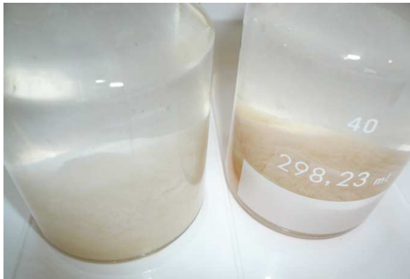
Abb. 2 Niederschlag nach Zugabe von Winkler I und II. Linke Probe ohne Sauerstoff (entspricht der Reaktion NUR mit Winkler I). Rechte Probe stark übersättigt (ca. 40%). Je mehr Sauerstoff enthalten war, desto dunkler wird der Niederschlag.
