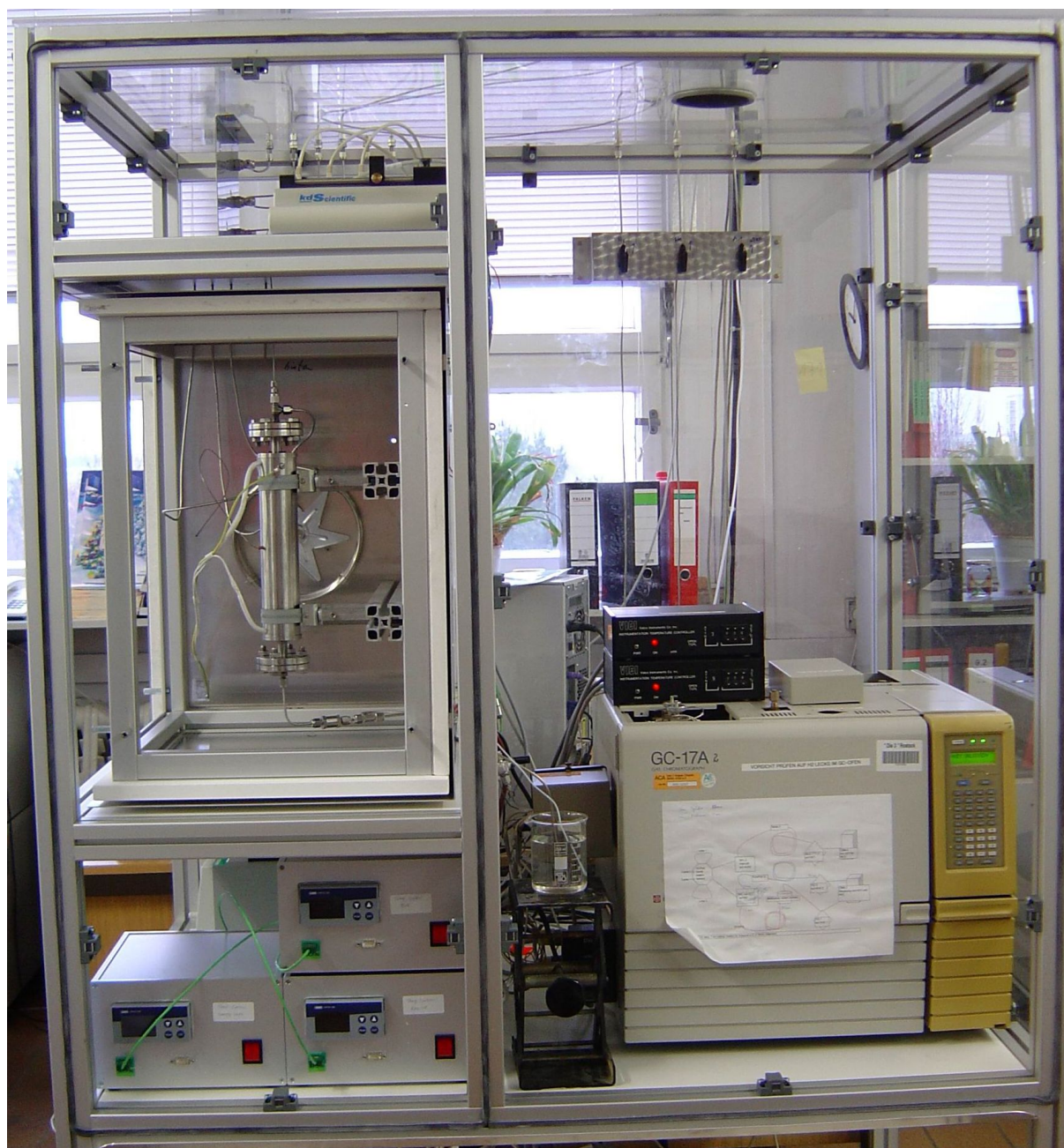
Abbildung 66: Kontinuierlich betriebener Reaktorstand für die katalytische Testung.
