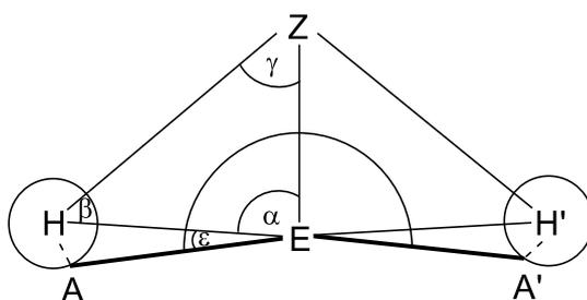
**Abbildung 34.** Visualisierung des Kegelwinkels  $\Omega$  nach Schulz.  $\Omega = 2(\alpha + \epsilon)$ .<sup>[55]</sup>
