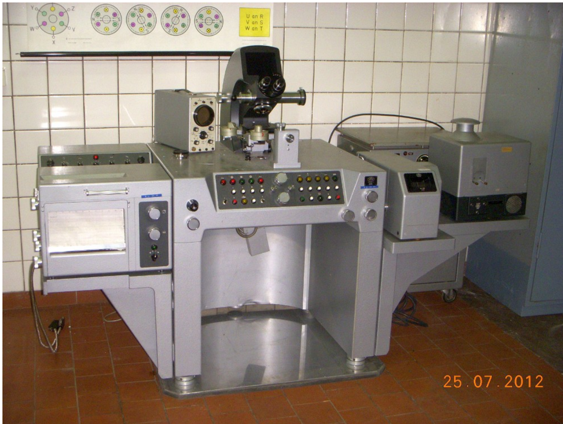
Fig. 36: Größere Mikroskope wie dieses Ultra-Mikrospektralphotometer UMSP I von Zeiss Oberkochen von 1962 wurden wahrscheinlich an allen anderen Orten „entsorgt“. (© D.G. Weiss)
