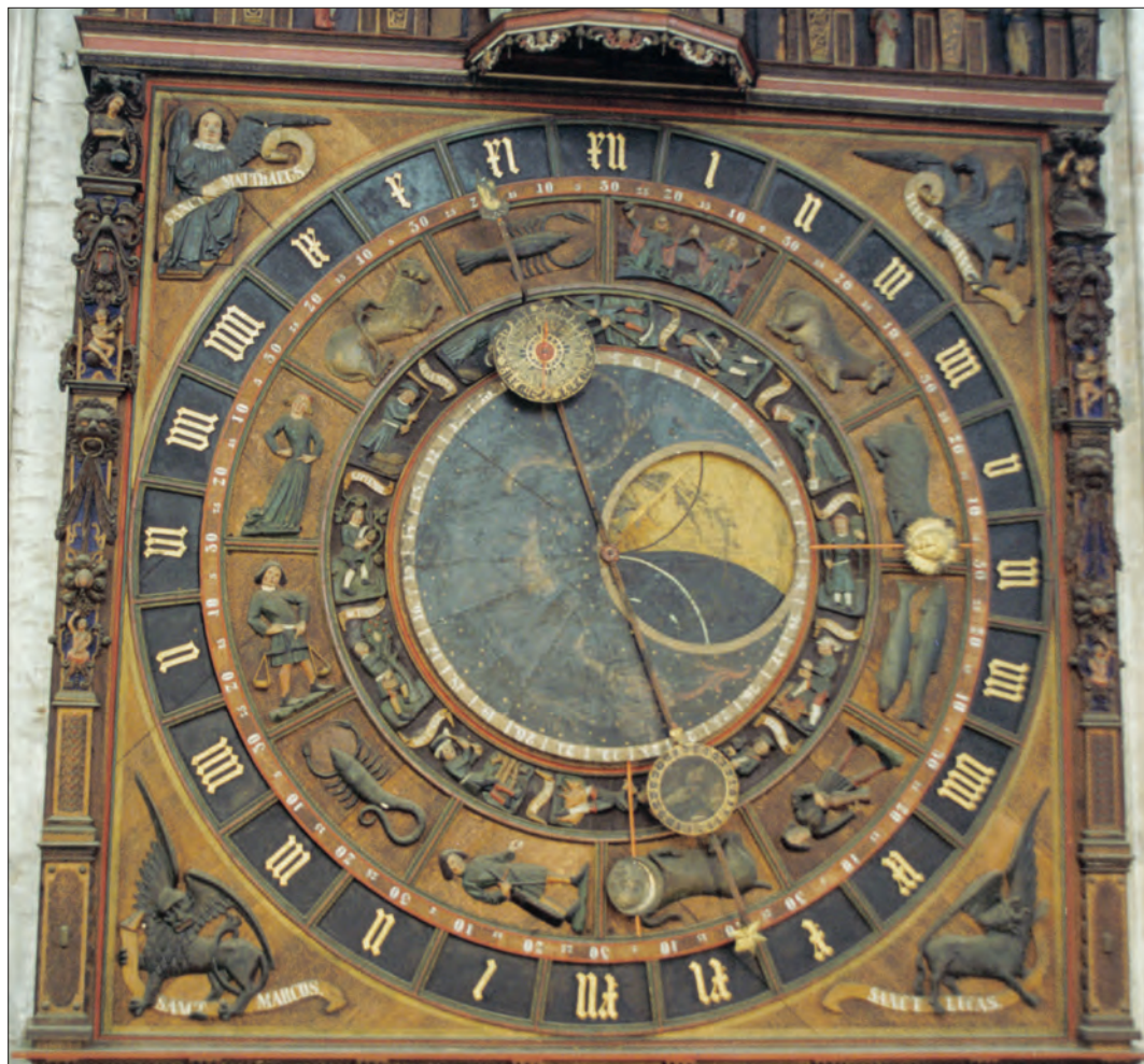
Abb. 2 Auf dem Zifferblatt der astronomischen Uhr in der Rostocker Marienkirche (jüngerer Typ) wird die Uhrzeit nur noch in den gleich langen (äquinoktialen) Stunden angegeben
