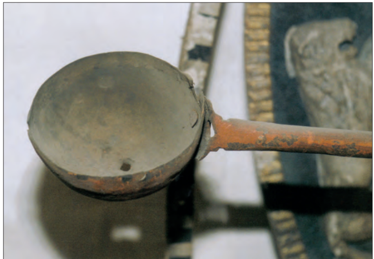
Abb. 4b Schale für die Aufnahme der Mondphasenkugel am Ende des Mondzeigers
