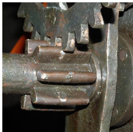
Abbildung 7: Volltrieb im Zeigerwerk
