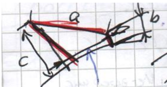
Abbildung 6: Skizze eines Zahns des Ankerrades
