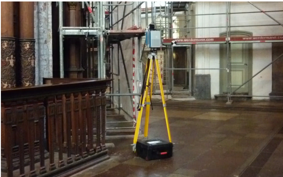
Abb. 35: Z+F IMAGER 5010 vor der Astrouhr (Scanner-Position 3)
