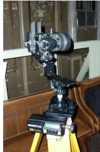
Abb. 39: Nikon D40 mit Nodalpunktadapter auf einem Stativ
