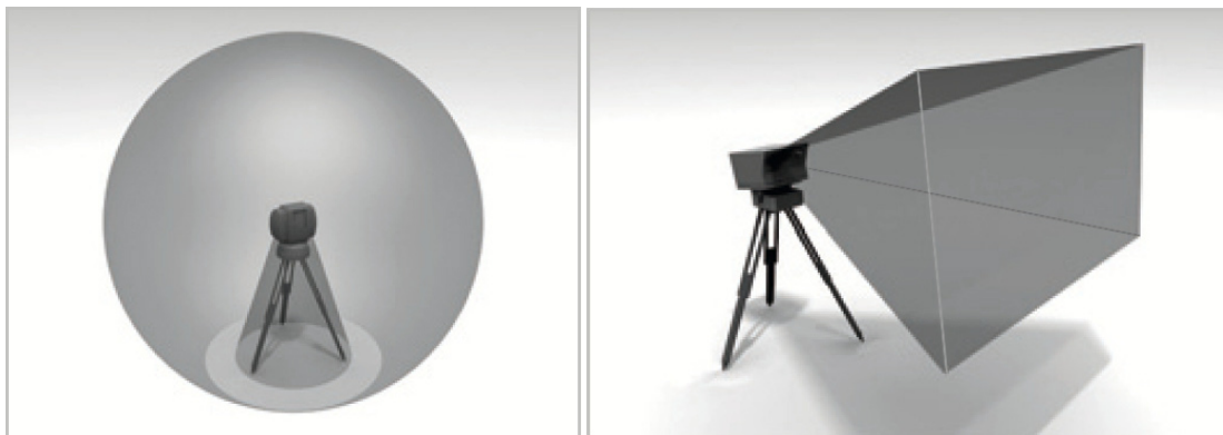
Abb. 3.2: Sichtfeld von Panorama-Scanner (links) und Kamera-Scanner (rechts) [nach DONATH 2008, S.113]
