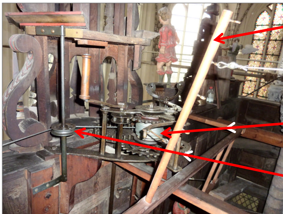
Das Apostelwerk mit der Auslösung über die hölzerne Wippe und dem Gewichtszug
