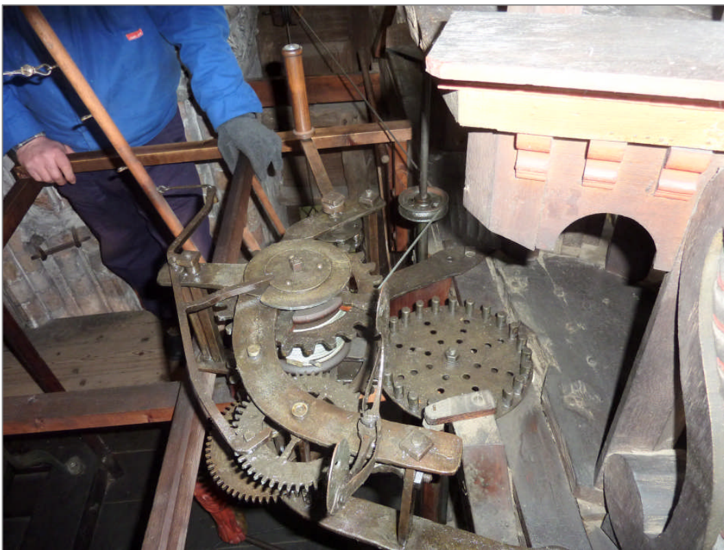
Das Apostelwerk, auf der oberen Etage der astronomischen Uhr, von oben gesehen.
