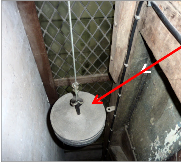
Die Scheiben aus Blei ruhen auf einem Tragstab.
