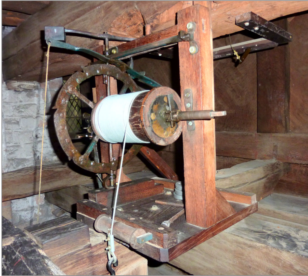
Der Antrieb für die Kalenderscheibe von der Seite gesehen, rechts das Wellenende mit dem wirkungslosen Vierkant für die Aufzugskurbel
