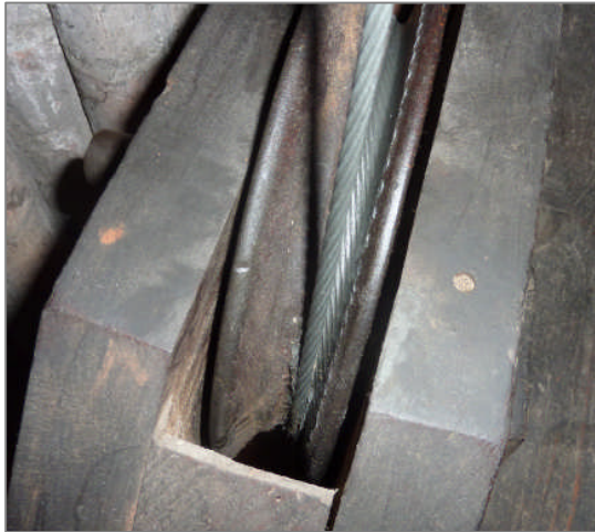
oben Seilrollen aus der Marienkirche, die durch falsche Seile, Stahlseile, zerstört wurden
