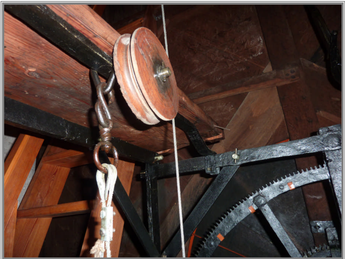
Originalfoto, einer Gewichtsanlage der astronomischen Uhr, Teilansicht, Standort: Marienkirche Rostock
