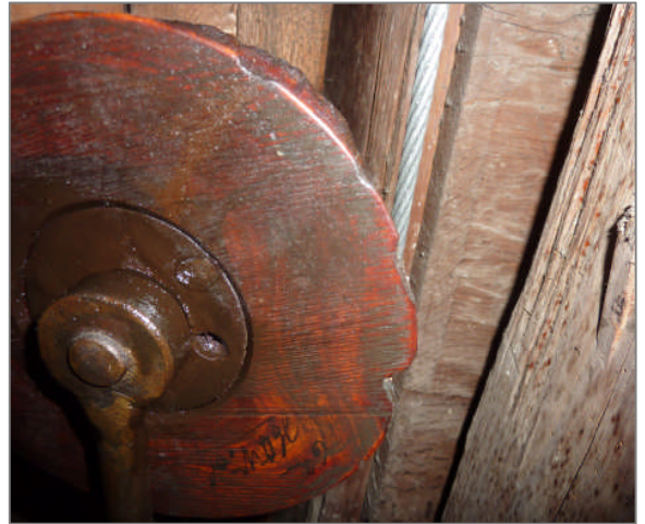
oben Seilrollen aus der Marienkirche, die durch falsche Seile, Stahlseile, zerstört wurden
