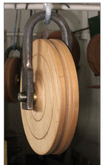
rechts eine neue Seilscheibe aus Holz, mit handgeschmiedetem Tragbügel, Messingachse und Stahlwelle nach historischem Vorbild
