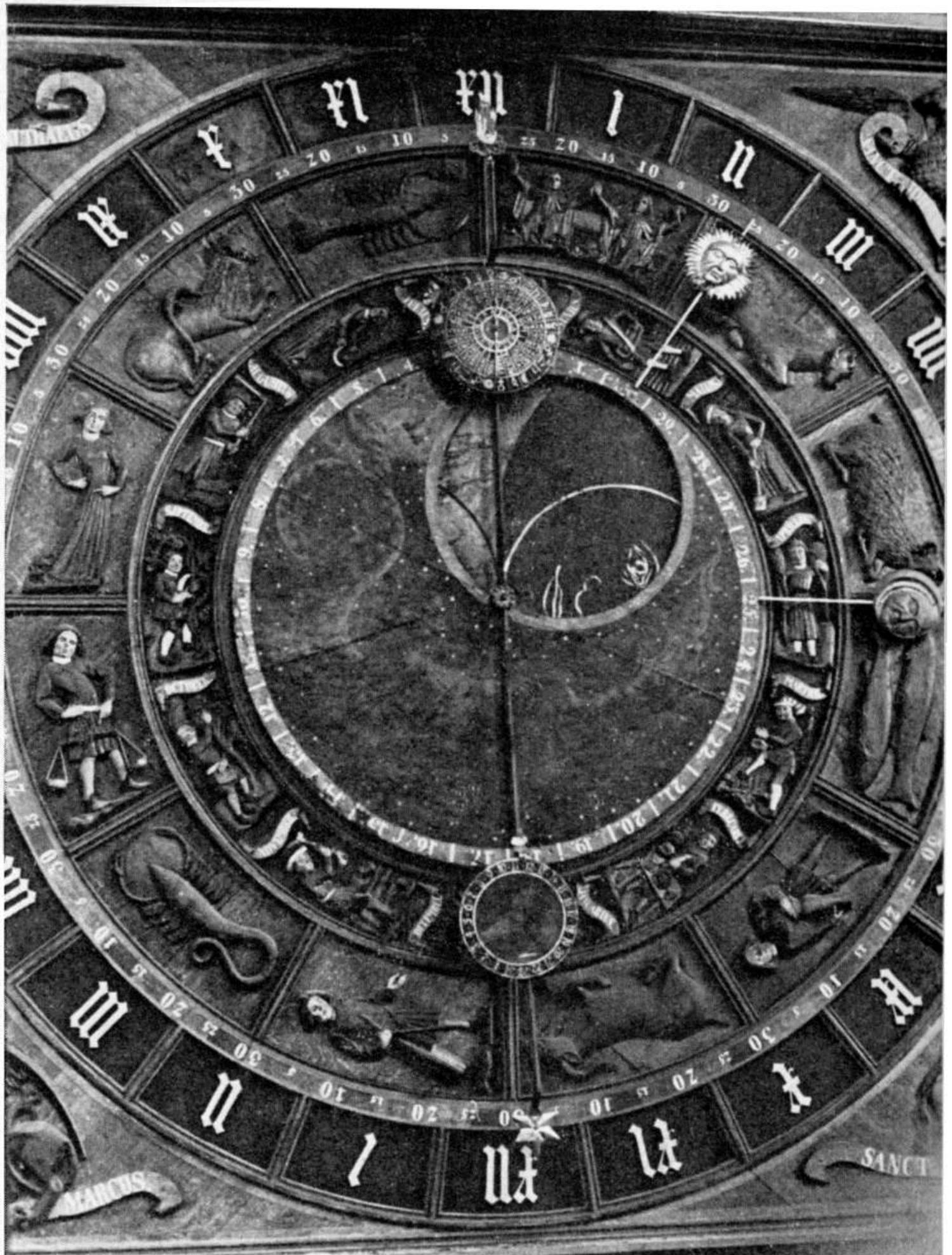
2: Das große Zifferblatt mit 24-Stundeneinteilung, Tierkreis, Sonnen- und Mondzeiger, Monatsbildern und Mondphasenanzeige
