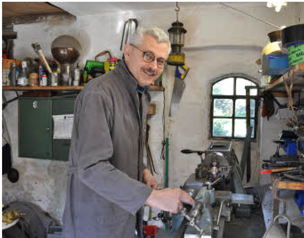
In seiner Werkstatt fertigt Uhrmachermeister Helmut Langner ein Bronzelager für die Astronomische Uhr. FOTO: JULIANE HINZ
