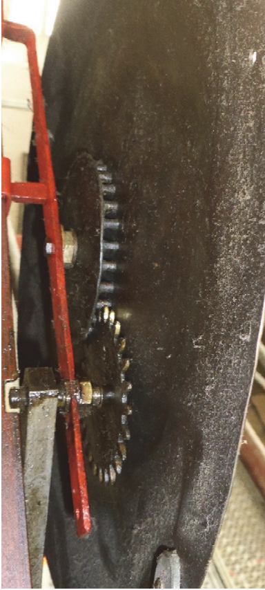
Bild 5 (links). Das Getriebe auf der Rückseite der astrologischen Scheibe Bild 6 (rechts). Ein Massestück fixiert das Zahnrad.
