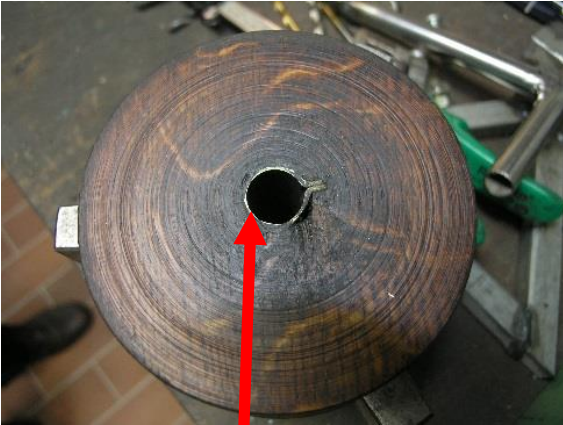
Die ausgeschlagene Buchse wird Rundgedreht.
