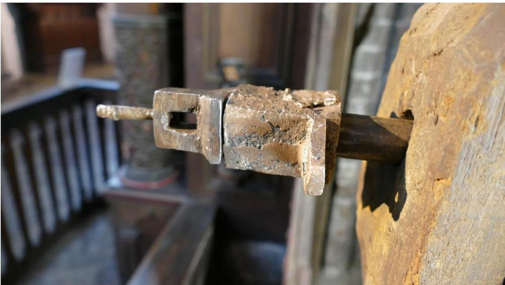
Die Bronzebuchse wird im Randbereich verdichtet und auf die Lagerwelle aufgepasst.
