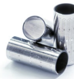
Prozessschritte bei der Herstellung von Stentstrukturen mittels Femtosekunden-Laserschneider – vom Schneiden der Rohrhalbzeuge über die mechanische Nachbearbeitung bis zur Formgebung durch Wärmebehandlung
