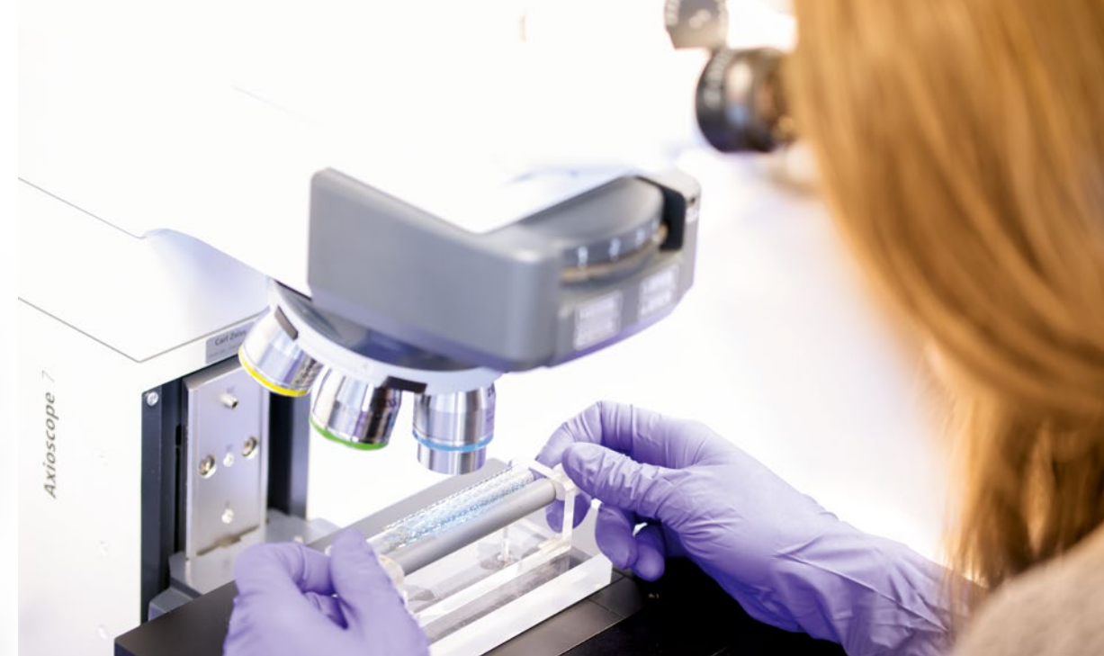
Lichtmikroskopische Analyse von Stents und deren Beschichtung als Qualitätskontrolle
