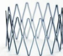
*Prozessschritte bei der Herstellung von Stentstrukturen mittels Femtosekunden-Laserschneider – vom Schneiden der Rohrröhlschlingen über die mechanische Nachbearbeitung bis zur Formgebung durch Wärmebehandlung*
