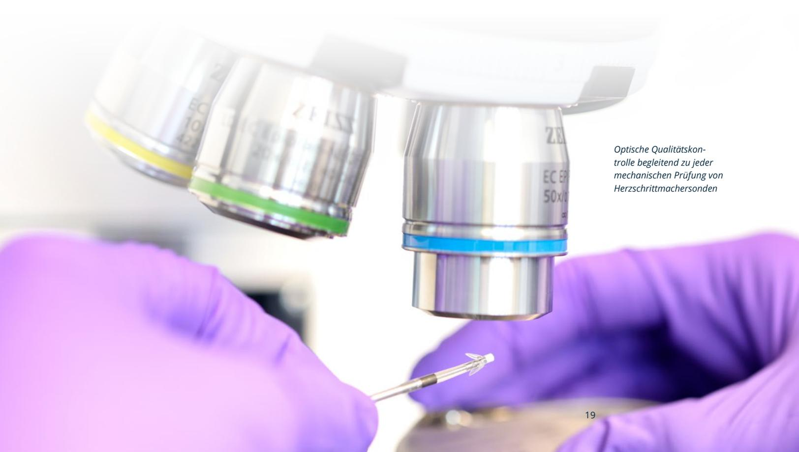
*Optische Qualitätskontrolle begleitend zu jeder mechanischen Prüfung von Herzschrittmachersonden*
