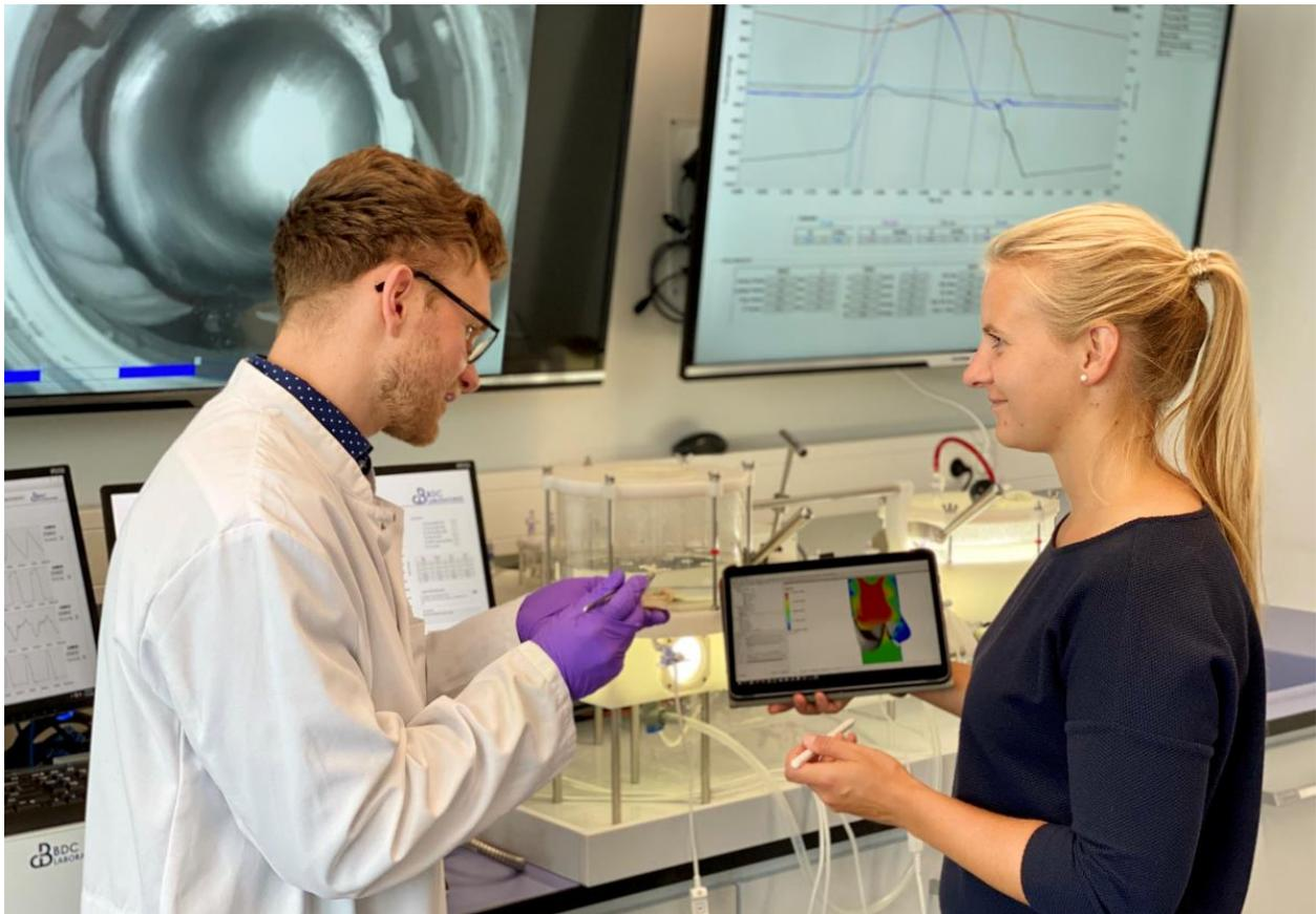
Robert Ott und Finja Borowski bei der Prüfung einer Aortenklappenprothese am hydraulischen Herzmodell im Labor der Biofluidmechanik des Instituts für ImplantatTechnologie und Biomaterialien e.V. (IIB e.V.).
