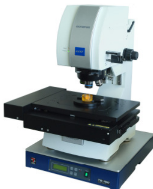
Konfokales Laser-Scanning-Mikroskop – Gerät Olympus LEXT 3000
