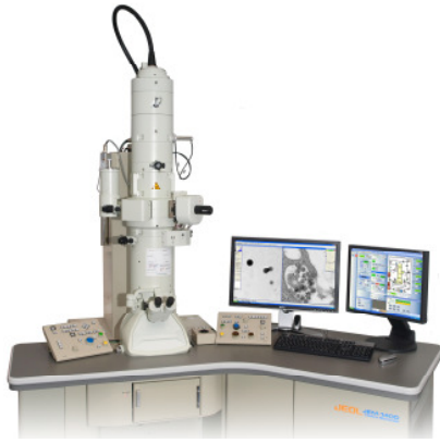
Transmissionselektronenmikroskop – Gerät JEOL JEM-1400. Gefördert aus Mitteln des Europäischen Fonds für regionale Entwicklung (EFRE) und des Europäischen Sozialfonds (ESF) im Rahmen der Verbundforschung zwischen Wirtschaft und Wissenschaft des Landes Mecklenburg-Vorpommern.
