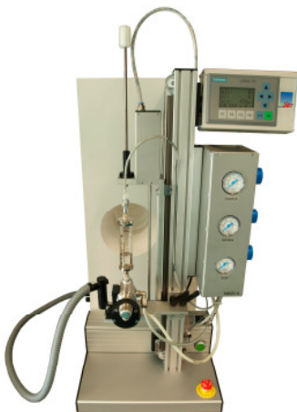
Beschichtungsanlage RAMSES – Beschichtung von Implantaten nach dem Airbrush-Prinzip
