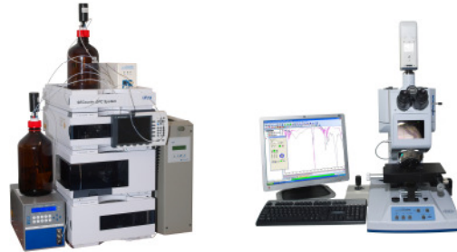
Chromatographie und Spektroskopie – Gelpermeationschromatographie zur Polymerdegradationsanalyse und Infrarotspektroskopie zur Polymeranalyse
