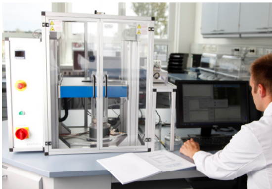
Stentprüfung – Laseroptische Bestimmung des Durchmessers von Ballonkathetern und Stentsystemen in Abhängigkeit vom Ballondruck
